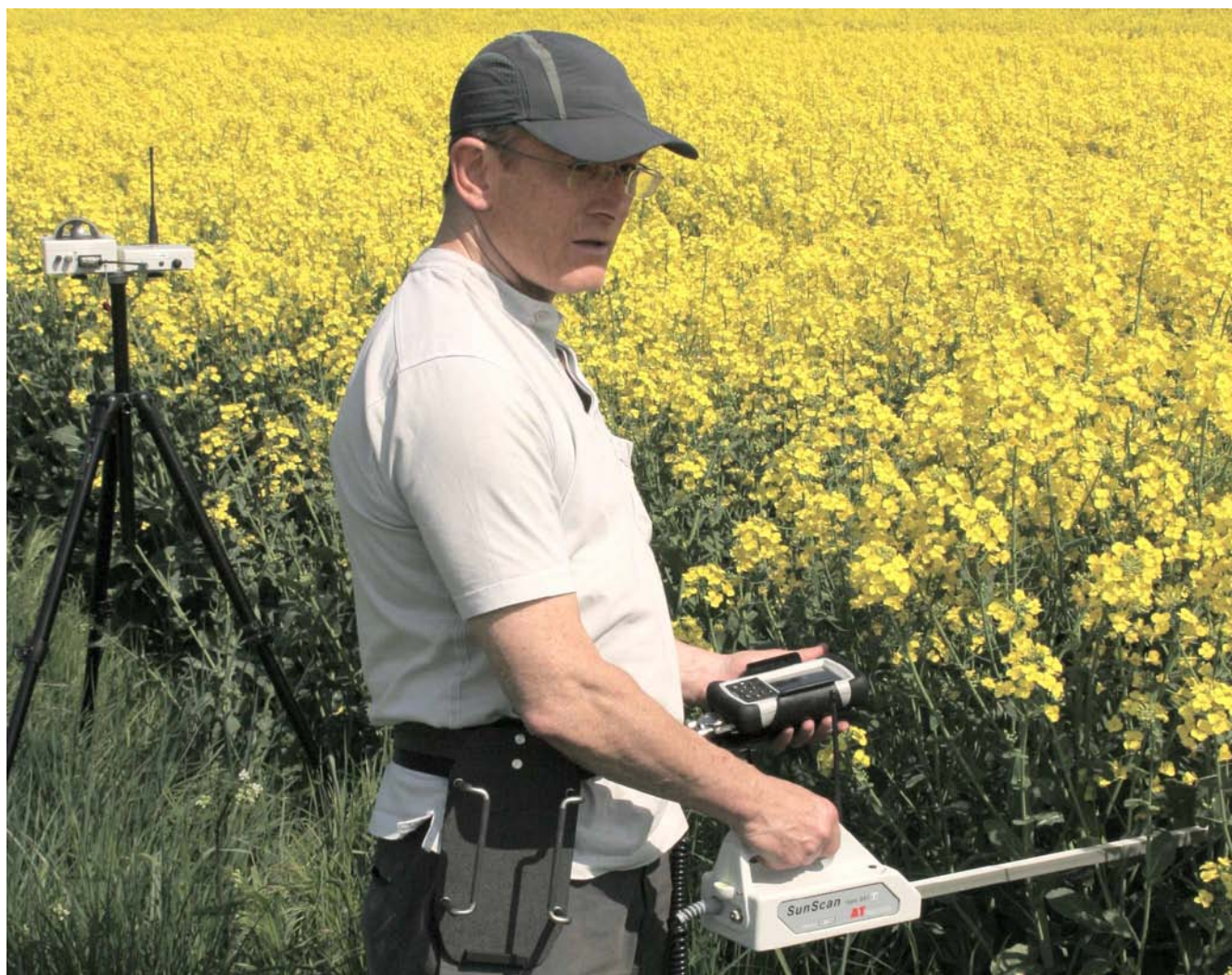
Sonda SunScan (versiunea semnal radio) și PDA, cu senzor solar BF3 (montat pe trepid) conectat prin semnal radio
